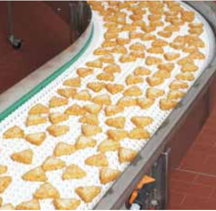
สายพาน Siegling Prolink แบบโค้งมีความเหมาะสม สำหรับการทำให้แห้งหรือการแช่แข็งแบบประหยัดพื้นที่
