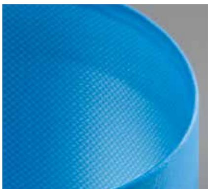
Las bandas Prosan™ cuentan con revestimiento en ambos lados y cumplen con todos los requisitos higiénicos. Los elementos tractores preencogidos y muy flexibles permiten que haya radios de retorno muy pequeños a pesar del revestimiento en ambos lados de la banda. Hay una patente pendiente para la nueva estructura del reverso (BT = Broken Twill, sarga cortada). Tiene un coeficiente de fricción especialmente bajo y es muy fácil de limpiar. La limpieza de la banda es rápida y sencilla.
