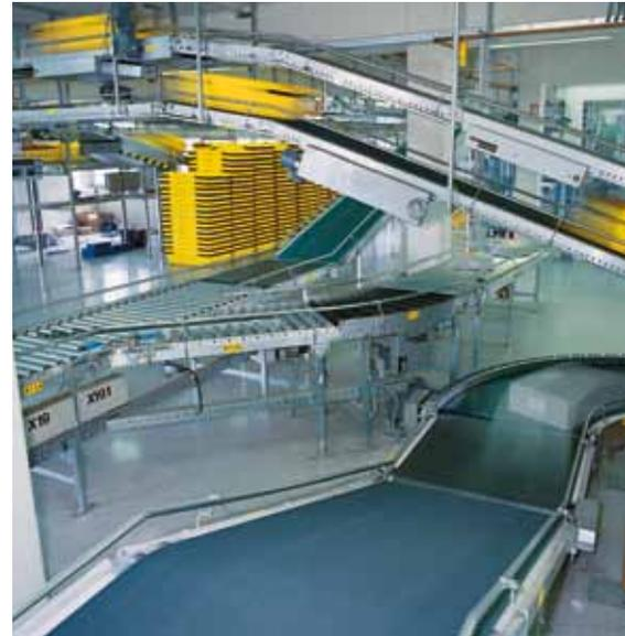
Forbo Siegling telah mengembangkan dan mengoptimalkan berbagai **pola permukaan** untuk penggunaan yang sangat berbeda. Dengan belt Siegling Transilon berpola, penghantaran menanjak dengan sudut miring hingga 30° dapat dicapai tanpa profil.
