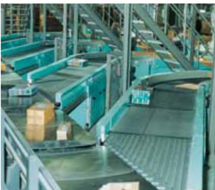
Dalam **menggabungkan** belt yang beroperasi dalam satu set, biasanya dilakukan dalam satu kali percobaan. Hal ini memerlukan toleransi pemanjangan yang rendah. Koefisien gesekan yang tinggi di bagian atas belt menjamin pemindahan yang tepat untuk penyortiran.
