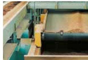
Horizontaltransport auf einem Shuttle zum Befüllen der Staubox. Die hier verwendeten Bandtypen mit glatten Oberflächen lassen sich auch zum Steigfördern bis ca. 20° einsetzen.
