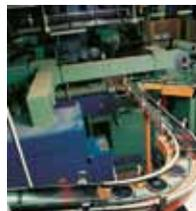
Zum Transport von Zigarettschachteln oder -stangen lassen sich mit Siegling Transilon Rundriemen auch komplizierte Förderstrecken einfach realisieren.
