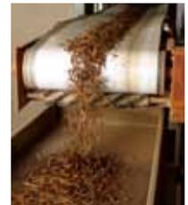
Transport mit einem muldungsfähigen Band.
