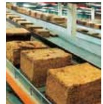
Ballentransport: Extreme Punktbelastung im Stop-and-Go-Betrieb.
