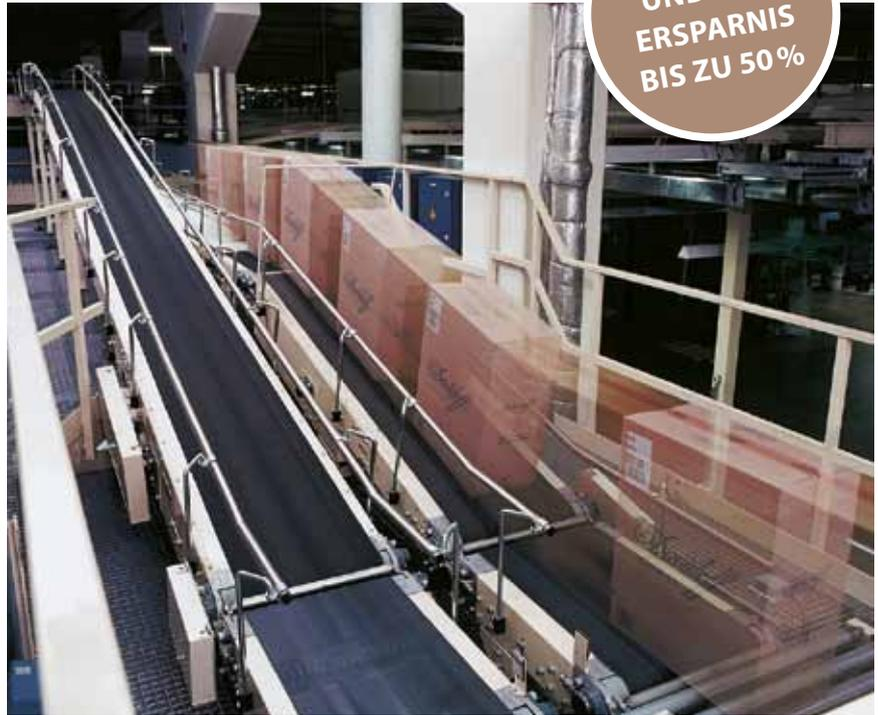
Starke Beschleunigungen im Stop-and-Go-Betrieb bei hohen Punktlasten stellen hohe Anforderungen an die eingesetzten Bänder.
