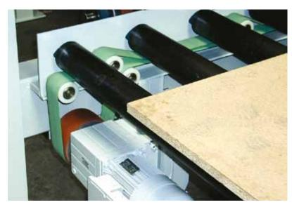
Signification de la désignation pour les courroies plates Siegling Extremultus GG 30E - 32 FSTR/FSTR noir **GT 40E** noir GG 14P - 30 vert Coloris Fine structure Epaisseur totale au 1/10 mm Matériau de la couche de traction Force tangentielle spécifique en [N/mm] de largeur de courroie Revêtement sur rouleaux de transport Revêtement sur rouleaux d'entraînement Aramide Polyamide Uréthane Polyester U Elastomère
