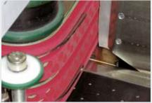
Les courroies plieuses-transporteuses Siegling Linpack (avec courroies revêtues de caoutchouc naturel Linatex) sont utilisées comme courroies d'évacuation dans l'industrie papetière et le tri de lettres.
