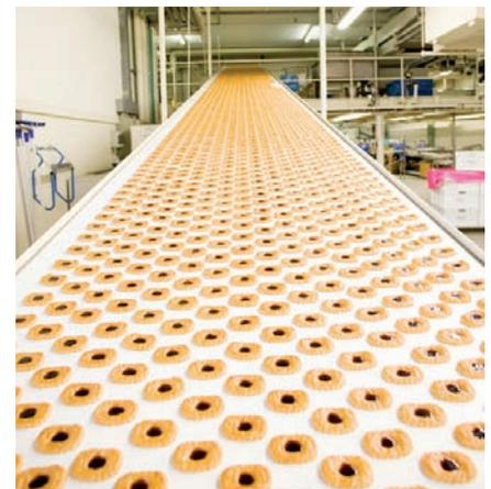
sehr leicht gereinigt werden kann. Da es sich um einen thermoplastischen Werkstoff handelt, ist die Verbindungstechnik viel einfacher und sicherer als bei alternativen Silikontypen. Außerdem ist bei Bedarf auch die Bandkantenversiegelung „Smartseal“ möglich. Die Grenzen der Temperaturbeständigkeit sind vergleichbar mit Urethanbandtypen. Somit steht fest: HighGrip ist sowohl technisch als auch preislich eine echte Alternative zu Silikonbändern.
